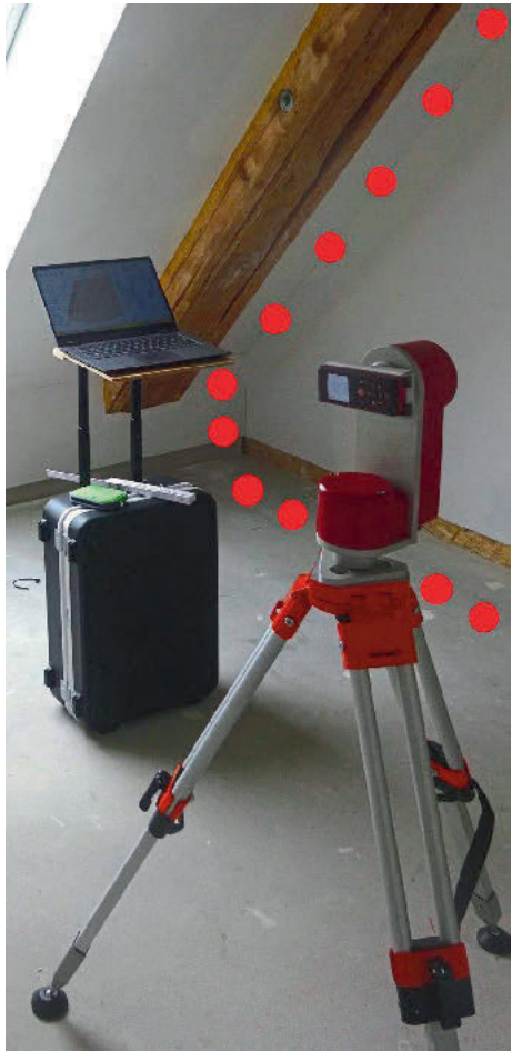
Foto: TheoCAD Mit TheoCAD zum exakten 3D-CAD-Aufmaß: Die Genauigkeit beträgt 1,5 mm pro Messpunkt.
